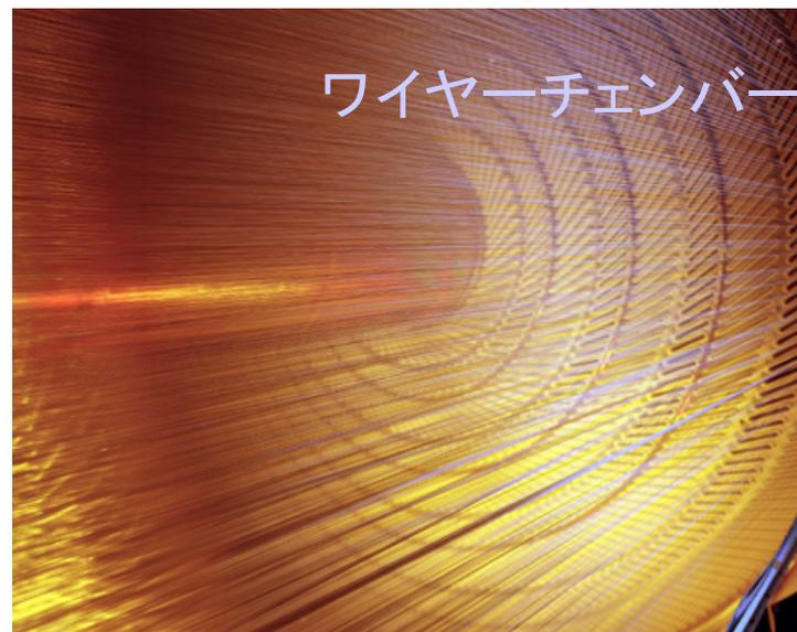
荷電粒子が通ると充満されているガスが電離してワイヤーに信号を残す
