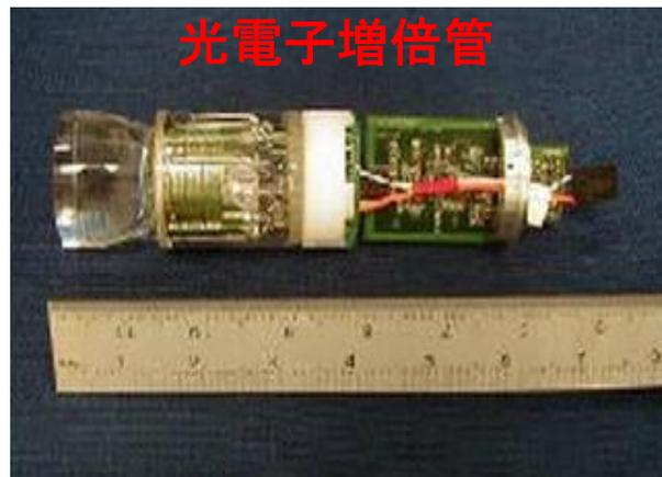
微弱な光を電気信号に変換する。
